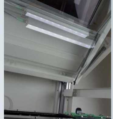
Floureszenz- oder Weisslicht - die Lampen strahlen auch beim Schwenken der Haube stets nach unten
