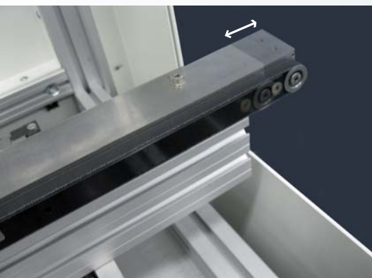
Zur optimalen Einpassung am Ein- und Auslauf sind die Längen der Transportschienen adaptierbar
