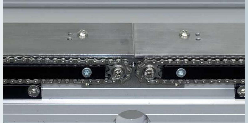
Wahlweise sind die Module mit ESD-Riemen- oder Kettentransport ausgestattet - auch zu mehreren Segmenten in einem Modul verfügbar
