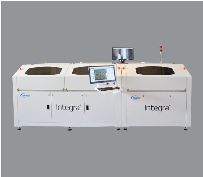
Integra™ 508.3 ist eine Mehrstationen-Selektivlötanlage, die für Massenanwendungen mit einem hohen Durchsatz konzipiert wurde. Dank ihrer hoch flexiblen Konfiguration ermöglicht die Integra® 508.3 das Löten von Leiterplatten in einer Größe von bis zu 508 x 700 mm.
