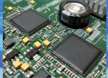
Dam & Fill Encapsulation
