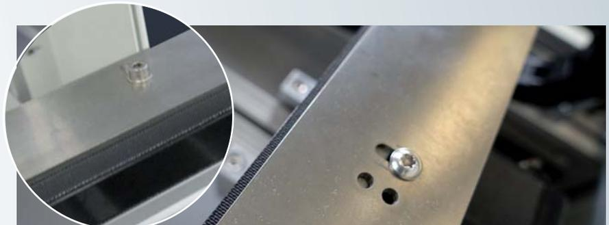
Auch die Auflagebreiten für die Leiterplatten lassen sich mit wenigen Handgriffen variieren.
