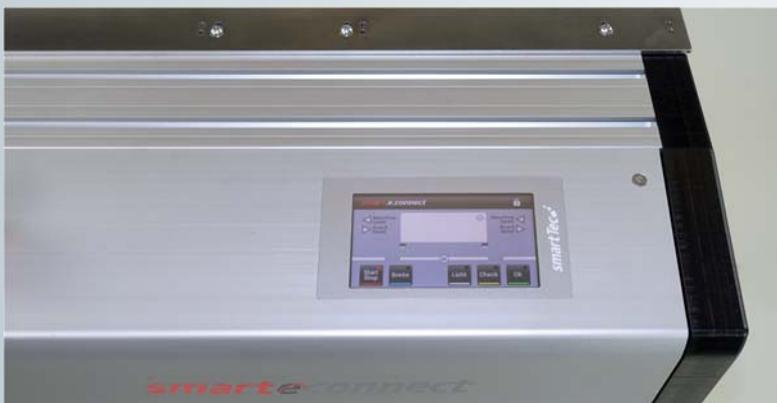
Das integrierte smartTouch Display - komfortable Schnittstelle für manuelle Eingaben und die Anzeige des Linienstatus
