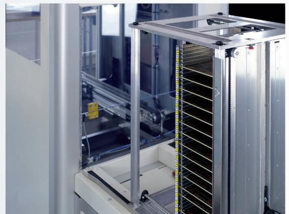
Automatische Ein- und Auslaufshutter für Sicherheit beim Be- und Entladen
