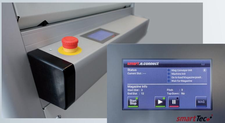
Das integrierte smartTouch Display - komfortable Schnittstelle für manuelle Eingaben und die Anzeige des Linienstatus
