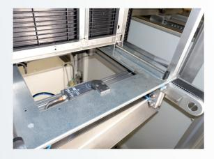
Erfassen und Verfolgen aller Magazine mittels integrierter RFID-Technologie
