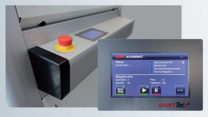
Das integrierte smartTouch Display - komfortable Schnittstelle für manuelle Eingaben und die Anzeige des Linienstatus
