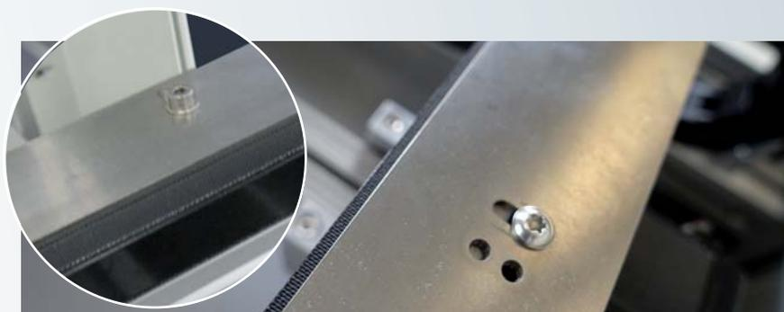
Auch die Auflagebreiten für die Leiterplatten lassen sich mit wenigen Handgriffen variieren.
