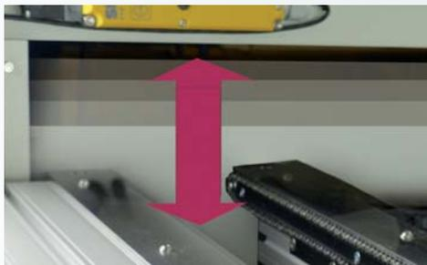
Pneumatische Shutter zur Absicherung benachbarter Maschinen
