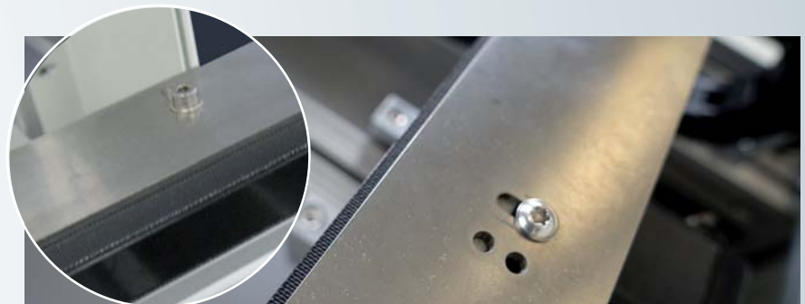
Auch die Auflagebreiten für die Leiterplatten lassen sich mit wenigen Handgriffen variieren.
