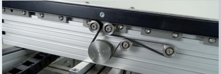
Wahlweise mit ESD-Riemen- oder Kettentransport - auch zu mehreren Segmenten in einem Modul verfügbar...
