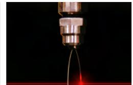
*Konturenscharf und sprühnebfrei: Lackvorhang mit laser-gesteuerter Auftragsbreite und Closed Loop Regelung*
