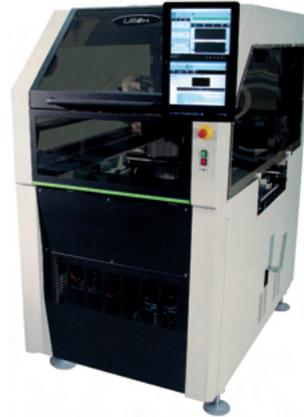
Das hochflexible, modular ausbaufähige Uflex System für die flexible Automatisierung von End-of-line Prozessen wie THT- und Exotenbestückung, Montage, Dosierung, Testhandlung oder Verschraubung bietet eine wirtschaftliche Lösung für alle Aufgaben, deren manuelle Durchführung aufgrund hoher Kosten ebenso wenig in Frage kommt wie die Beschaffung teurer Spezialvorrichtungen.
